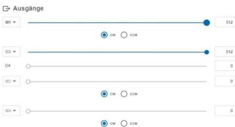
Zum Schluss testest du noch den angeschlossenen Encodermotor. Dazu ziehst du den Regler von „M1“ nach rechts. Der Motor läuft mit der vollen Geschwindigkeit.
