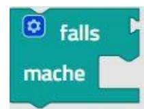
Für „falls“ wird abgefragt welcher Abstand am Ultraschallsensor gemessen wird. Ist der Abstand kleiner (<)10 (cm) soll bei „mache“ der Motor starten. Den Befehl für den Ultraschallsensor findest du in der Gruppe „Eingang“.
