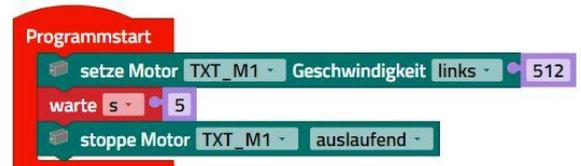
Dazu aktivierst du die Schaltfläche „Programm starten“. Das Programm wird jetzt zum Controller gesendet und gestartet. Der Motor läuft 5 Sekunden und schaltet dann wieder ab.
