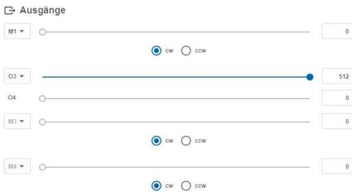
Möchtest du den Fototransistor testen, musst du zuerst den Schieberegler 03 im Fenster „Ausgänge“ nach rechts schieben. Dadurch wird die Lichtschranken-LED eingeschaltet. Der Wert des Fototransistors wird auf „1“ geschaltet. Unterbrichst du den Lichtstrahl, wechselt der Wert auf „0“.
