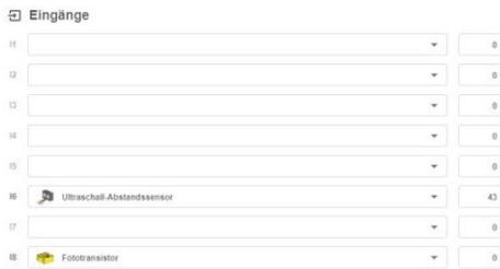
Betrachte zuerst den Bereich „Eingänge“. Hier werden die beiden Sensoren „Fototransistor“ und „Ultraschall-Abstandssensor“ angezeigt.
