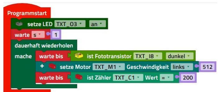
Anschließend fügst du noch aus dem Block „Motor“ den Befehl „stoppe Motor“ und darunter aus dem Block „Zähler“ den Befehl „setzt Zähler zurück“ ein.
