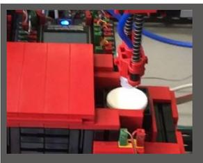
Der Vakuum-Sauggreifarm dreht in die Ablageposition, fährt nach unten und legt die Rohware in den bereitstehenden Container ab.
