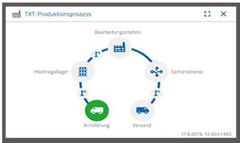
Legen Sie einen weißen Stein in die Materialeingabe ein. Das Werkstück (Rohware) unterbricht die Lichtschranke. Dieser Vorgang wird als „Anlieferung“ erkannt und im Dashboardfenster „Produktions-prozess“ mit dem Icon „Anlieferung“ grün hervorgehoben dargestellt.
