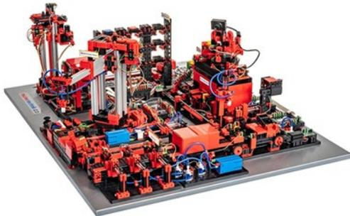
Die Basis zur Entwicklung der Lernfabrik 4.0 ist die bereits bekannte vollautomatisierte fischertechnik Fabriksimulation.
