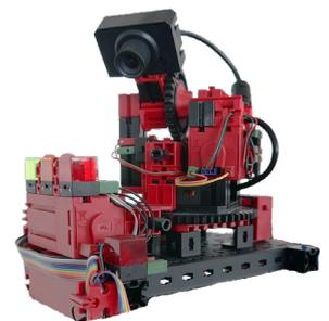
Die einzelnen Werkstücke werden durch NFC (Near Field Communication) getrackt: Jedes Werkstück erhält eine eindeutige Identifikationsnummer (ID). Das ermöglicht die Rückverfolgung und Sichtbarkeit des aktuellen Status der Werkstücke im Bearbeitungsprozess.
