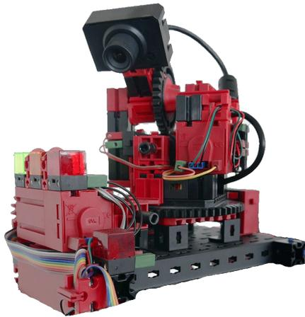
In der Fabrikanlage wurden die beiden Module „Multi-Bearbeitungszentrum und Überwachungskamera“ zu einem Gesamtmodul zusammengefasst. Dies hat den Vorteil, dass die Kamera an höchster Stelle im Fabrikmodell steht und somit die gesamte Anlage überwachen kann. Die Überwachungskamera besitzt noch eine optische Anzeige (rote Lampe). Durch Blinken wird angezeigt, dass Bilder aufgezeichnet werden.
