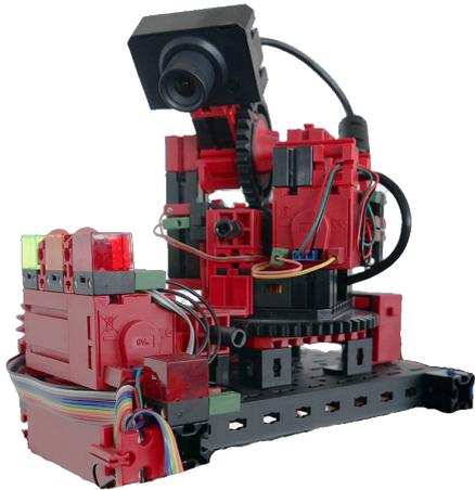
Die Umweltstation mit Überwachungskamera dient zur Erfassung von Messwerten innerhalb der Fabrik. Die bewegliche Kamerastation ist auf der Multi-Bearbeitungsstation aufgebaut und dient dazu, die Anlage optisch zu überwachen.
