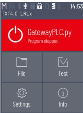
Beim Einschalten des TXT 4.0 Controllers wird das Programm automatisch durch den „Auto Load“ geladen und muss nur noch gestartet werden, indem auf dem Touch-Display „Start Programm“ betätigt wird.
