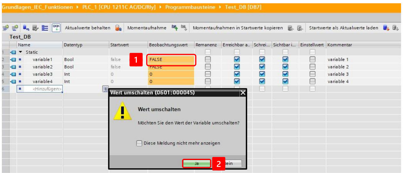
Bild 12 Datenbaustein boolesche Variable umschalten
