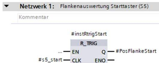
5. Programmieren Sie im nächsten Netzwerk die Initialisierung der Kette. Aus der Funktionsbeschreibung geht hervor, dass die Schrittkette initialisiert werden soll, wenn der Starttaster betätigt wird (Positive Flanke) und die Kette sich nicht im Initialschritt (SR01) befindet:
