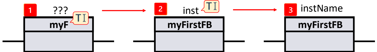
Bild 12 Funktionsbausteinaufruf aus Leerbox
