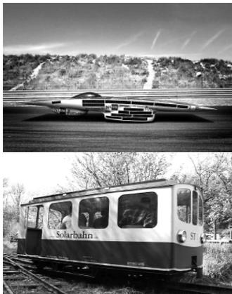
■ Los vehículos solares reciben una gran parte de su energía de accionamiento directamente del sol. Para ello están equipados en su superficie con celdas solares, que convierte la energía solar sobre el vehículo en corriente eléctrica. Como vehículos eléctricos llevan frecuentemente también un acumulador de energía (en la mayoría de los casos baterías), para que hasta bajo malas condiciones de luz o cielo cubierto permanecer por lo menos un tiempo limitado con capacidad de funcionamiento.
